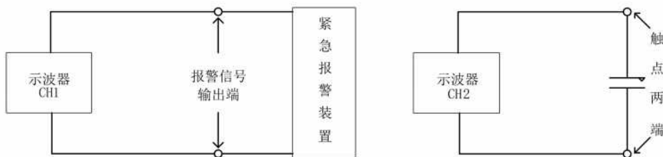
图 3 有源装置触发报警响应时间试验电路
